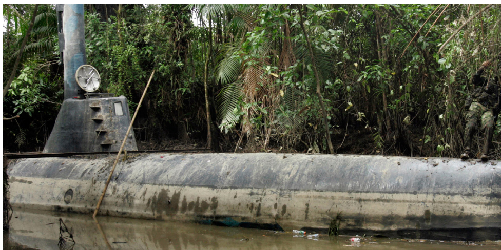
Colombia - Sequestro di un sommergibile in vetroresina di 30 mt. di lunghezza per un carico massimo di 8 tonn. costruito per il contrabbando di stupefacenti
